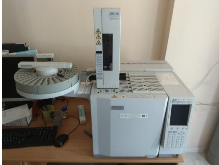
Σχήμα 3.7: Αέριος χρωματογράφος GC-2010 plusAT, SHIMADZU με ανιχνευτή ιονισμού φλόγας (FID)
