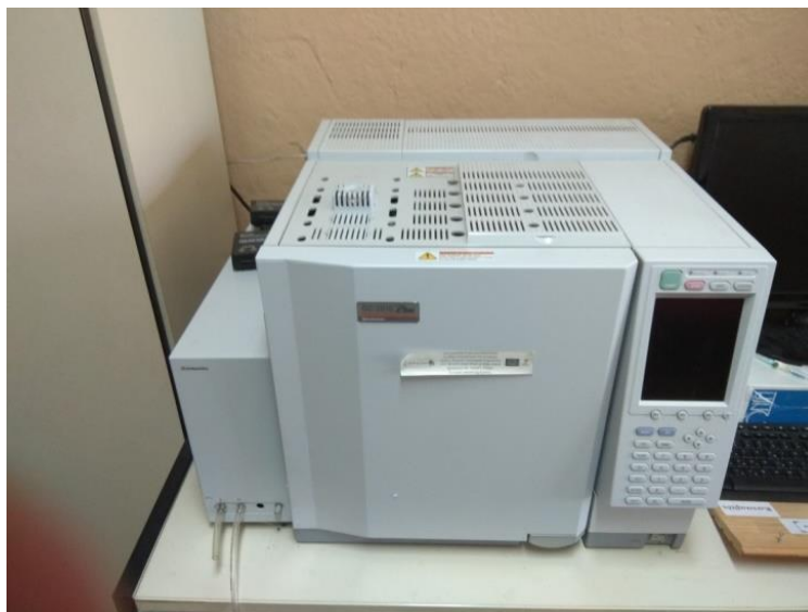
Σχήμα 3.8 Αέριος χρωματογράφος GC-2010 plusAT, SHIMADZU με ανιχνευτή θερμικής αγωγιμότητας (TCD)
