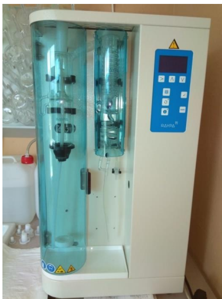
Σχήμα 3.5: Συσκευή Kjeldahl της εταιρίας Raypa
